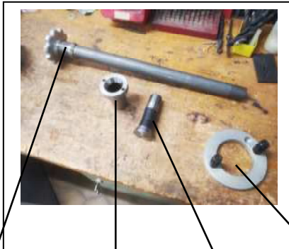
Spannrohr – Aufnahmhülse – Spannzange - Haltering
