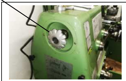
Spannrohr – Aufnahmhülse – Spannzange - Haltering
