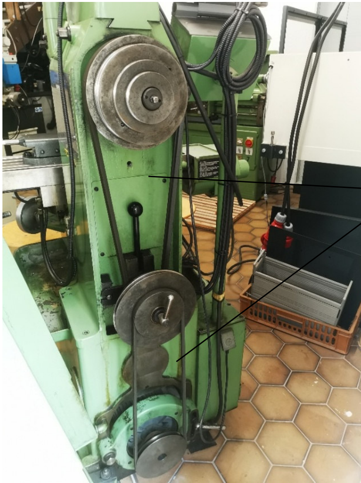
Obere Keilriemenstufe – Spanneinrichtung
