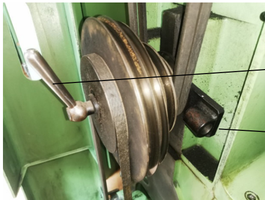
Obere Keilriemenstufe – Spanneinrichtung
