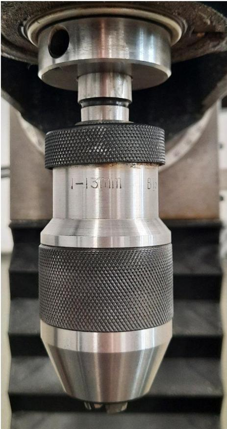
Leider scheint das Bohrfutter aber auch unrund zu laufen: In einer ersten Messung (per Hand gedreht) ca. 1/10 mm gesamt (bzw. -0.05 bis +0.05mm). Oben an der Aufnahme an der Spindel scheint es keine nennenswerte Unwucht zu geben (die Messung dort war +/- 0.00 mm).
