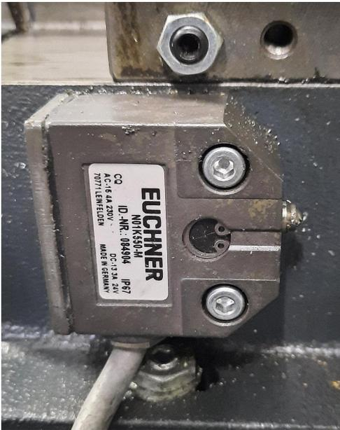
3. **Kabinentaster** - an der Kabinentür ist ein Metallstift befestigt, der beim Schließen der Tür einen Taster betätigt. Der Kontakt geht über ein Kabel in das Kontroll-Panel, und wird von dort weitergeleitet (Rundstecker) zur Steuerplatine. Die Frässpindel läuft unabhängig vom Schaltzustand des Kabinentasters - um eine manuelle Nutzung der Maschine zu ermöglichen.
