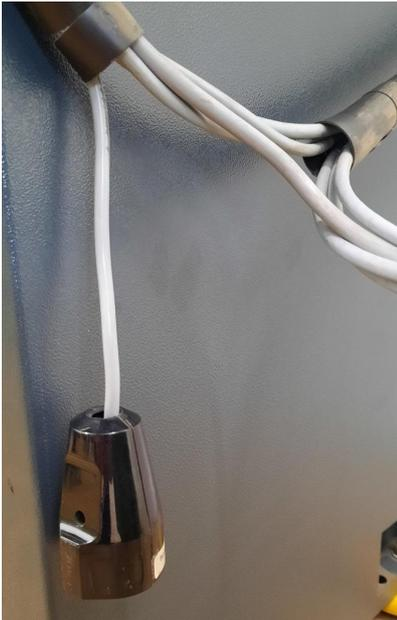
Die Steckdose ist über die Steuer-Elektronik und Schrittmotor-Treiber angeschlossen sein, sodass sie im Falle des Notaus stromlos geschaltet werden.
