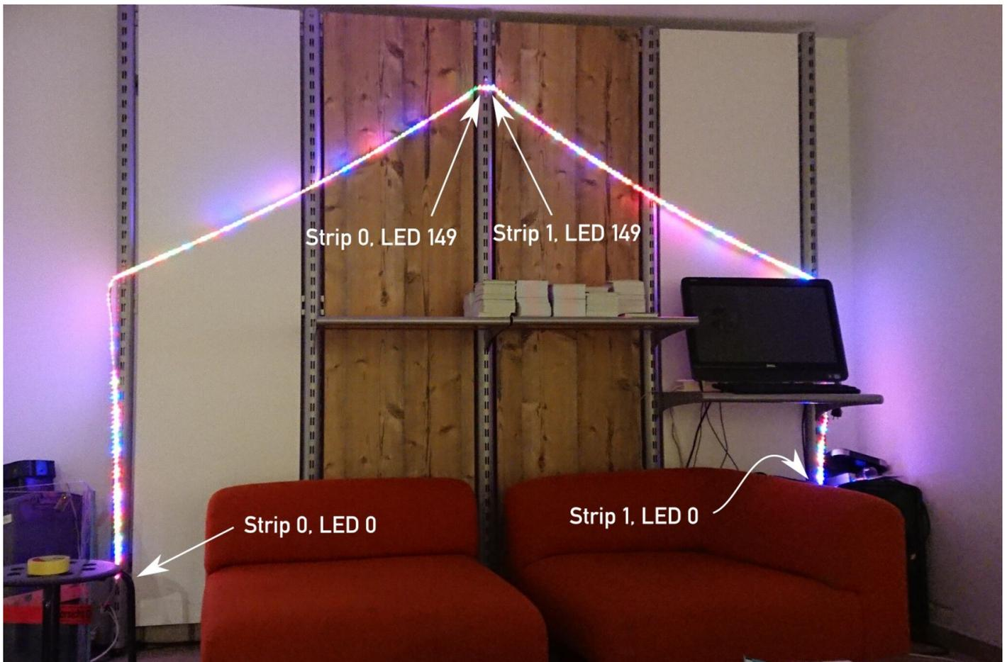
Wie man sieht, ist der Strip in zwei logische Strips aufgeteilt, die jeweils aus 150 LEDs bestehen und „von unten nach oben“ adressiert werden. Dies erlaubt die einfachere Programmierung von symmetrischen Animationen.
