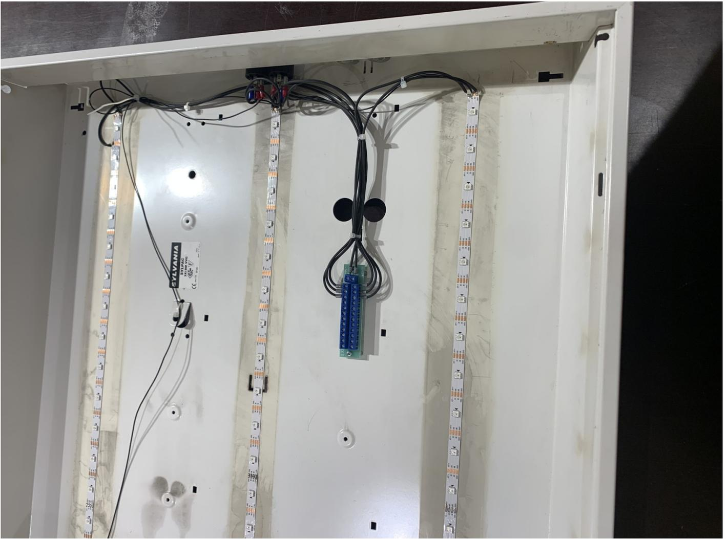
Hier der zweite Prototyp mit erweiterter Klemme für zukünftige Erweiterungen (Warm White LED Stripe, mehr RGB). Im Bild ist auch zu erkennen, dass die Stromversorgung direkt gebrückt zum Ausgang ist und die 3 LED Streifen Parallel mit 12 V versorgt werden, damit der Strom auf den LED-Streifen nicht zu groß wird.
