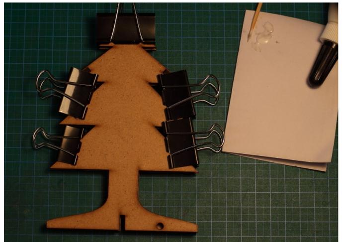
Nach dem Trocknen des Leims können die *Baumformplatten* auseinandergehebelt und die Plattenteile anschließend mit Grundierung gestrichen werden.
