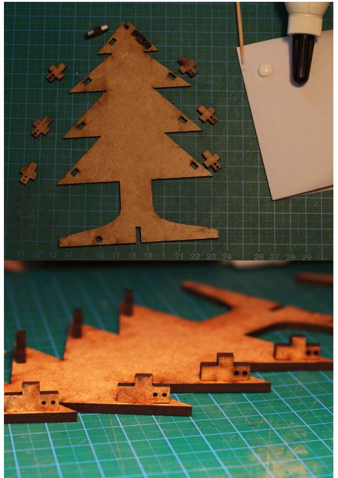
Legen Sie die andere *Baumformplatte* vorsichtig auf die frisch geklebten *Abstandshalter* und verwenden Sie Foldbackklammern, um Druck auf die Baugruppe auszuüben. Dadurch wird sichergestellt, dass die *Abstandshalter* während des Trocknens des Klebers richtig eingebettet werden und dass die *Baumformplatte* später richtig zusammenpassen.
