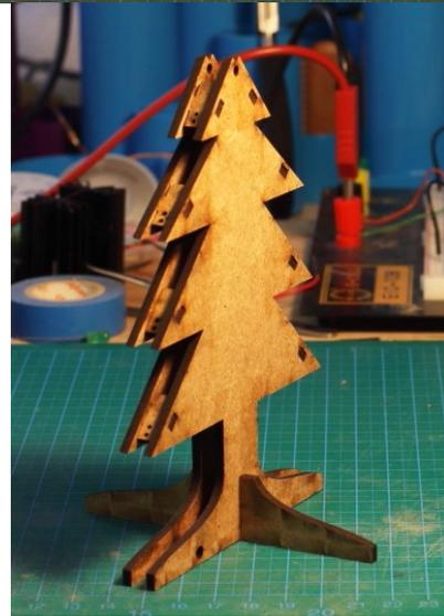
Kleben Sie die *Abstandshalter* nur auf eine *Baumformplatte*. Dies schafft eine solide Basis, um die LEDs zu montieren
