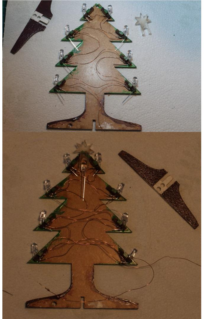
Bringen Sie den Stecker und den Batterieclip an. Legen Sie den Akku ein und testen Sie die Verbindungen. Nehmen Sie Korrekturen vor, wenn einige der LEDs nicht leuchten.
