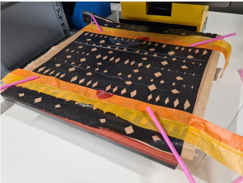
In der Heat press legst du dein Muster so aus, wie es von der Hitze verschmolzen werden soll. Achte darauf, dass es von einer Lage Teflonpapier (Backpapier) abgedeckt ist. So verhinderst du, dass die Folie an der Heat press festklebt.
