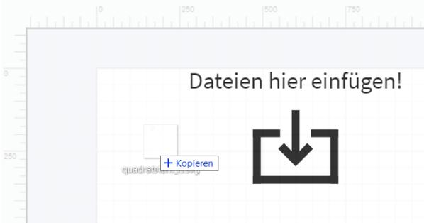
5. Die eingefügte Grafik hat in Ruby die "Anfasser" mit den Abmessungen der ursprünglichen **Dokumenten-Größe** (im Beispielbild 210x297 mm - also DIN A4), nicht der **Grafik-Größe** (hier 30x30 mm)
